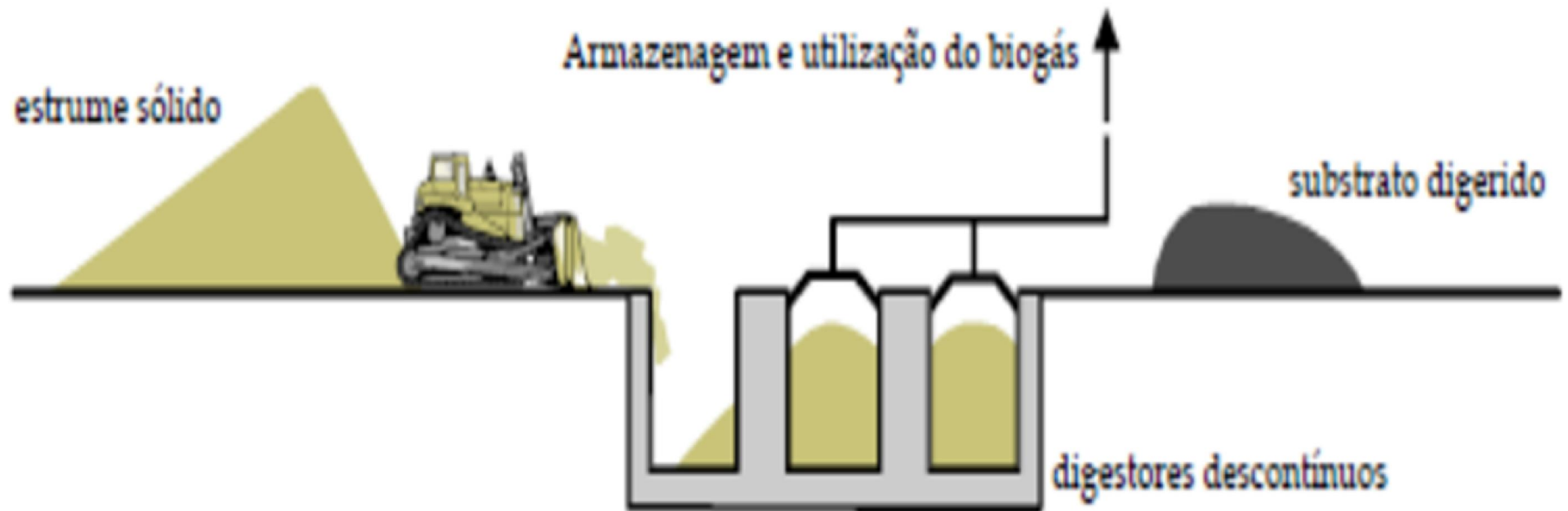
Figura 8.12 – Sistema descontínuo (batelada) de produção de biogás.
