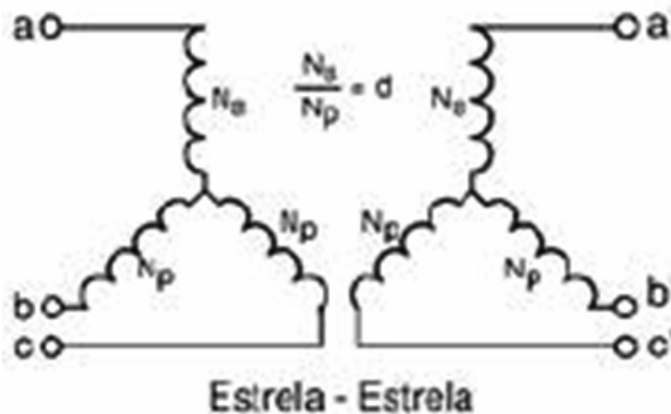
Figura – Esquema de ligação dos enrolamentos primário e secundário dos transformadores trifásicos.
