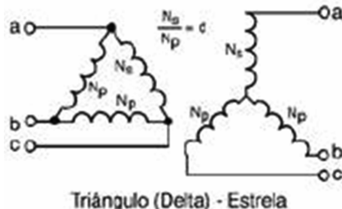
Figura – Esquema de ligação dos enrolamentos primário e secundário dos transformadores trifásicos.
