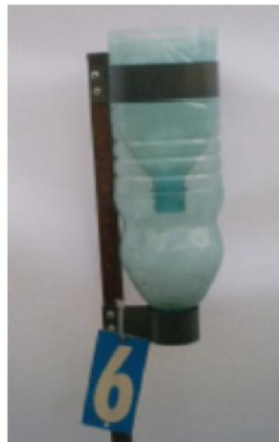
Figura 2.3 – Pluviômetro alternativo feito com garrafa PET de água mineral (1,5 L), testado por Souza et al. (2013)
