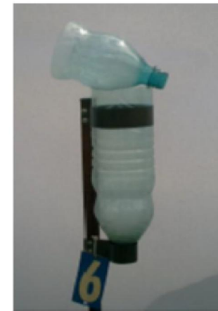
Figura 2.3 – Pluviômetro alternativo feito com garrafa PET de água mineral (1,5 L), testado por Souza et al. (2013)
