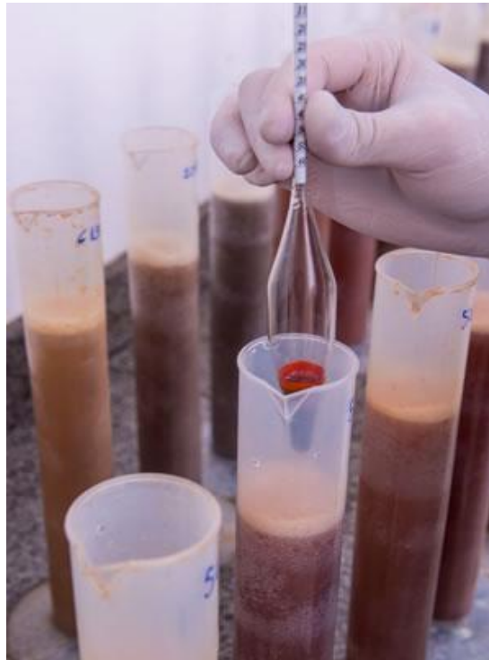
FIGURA A1.1 – REALIZAÇÃO DO MÉTODO DO DENSÍMETRO EM LABORATÓRIO PARA DETERMINAÇÃO DE TEXTURA DO SOLO.
