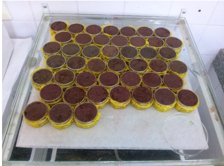
FIGURA A4.1 – AMOSTRAS INDEFORMADAS DE SOLO, COLETADA COM ANEL VOLUMÉTRICO, EM MESA DE TENSÃO DE 60 cm DE COLUNA DE ÁGUA, PARA DETERMINAÇÃO DE UMIDADE NA CAPACIDADE DE CAMPO.
