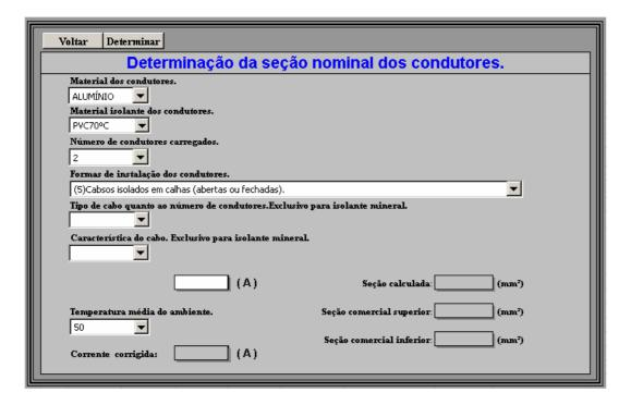
Figura 2 – Formulário do programa "Dimensionamento de Condutores Elétricos"
